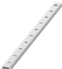
Repérage ZB, plat, Rubans, blanc, repéré, impression longitudinale: numérotation continue 1 ... 10, 11 ... 20, etc. jusqu'à 91 ... 100, type de montage: encliquetage dans la rainure de repérage plate, pour bloc de jonction au pas de : 10 mm, surface utile: 5,15 x 10 mm, Nombre d'étiquettes: 10
