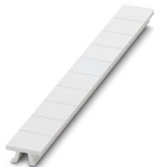
Repérage ZB, Rubans, blanc, vierge, repérable avec : PLOTMARK, CMS-P1-PLOTTER, type de montage: encliquetage dans la rainure de repérage élevée, pour bloc de jonction au pas de : 10,2 mm, surface utile: 10,5 x 10,15 mm, Nombre d'étiquettes: 10
