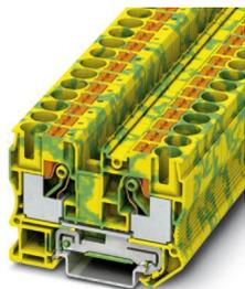
Bloc de jonction pour conducteur de protection, nombre de connexions: 2, type de raccordement: Raccordement Push-in, 1er étage, Section de référence: 10 mm<sup>2</sup>, section : 0,5 mm<sup>2</sup> - 16 mm<sup>2</sup>, type de montage: NS 35/7,5, NS 35/15, coloris: vert/jaune
