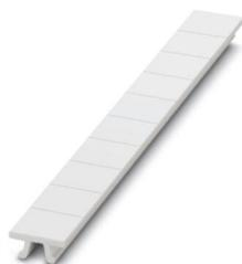
Repérage ZB, à commander : par bandes, blanc, impression selon les indications du client, type de montage: encliquetage dans la rainure de repérage élevée, pour bloc de jonction au pas de : 10,2 mm, surface utile: 10,15 x 10,5 mm, Nombre d'étiquettes: 10
