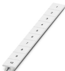
Repérage ZB, Rubans, blanc, repéré, repérable avec : CMS-P1-PLOTTER, impression transversale: numérotation continue 1 ... 10, 11 ... 20, etc. jusqu'à 91 ... 100, type de montage: encliquetage dans la rainure de repérage élevée, pour bloc de jonction au pas de : 10,2 mm, surface utile: 10,15 x 10,5 mm, Nombre d'étiquettes: 10
