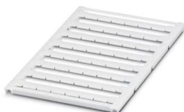
Repères pour blocs de jonction, Planche, blanc, vierge, repérable avec : BLUEMARK ID COLOR, BLUEMARK ID, BLUEMARK CLED, PLOTMARK, CMS-P1-PLOTTER, type de montage: encliquetage dans la rainure de repérage plate, pour bloc de jonction au pas de : 10,2 mm, surface utile: 9,6 x 5,1 mm, Nombre d'étiquettes: 48
