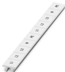
Repères pour blocs de jonction, Rubans, blanc, repéré, repérable avec : CMS-P1-PLOTTER, longitudinal: L1, L2, L3, N, PE, L1, L2, L3, N, PE, type de montage: encliquetage dans la rainure de repérage élevée, pour bloc de jonction au pas de : 10,2 mm, surface utile: 10,15 x 10,5 mm, Nombre d'étiquettes: 10
