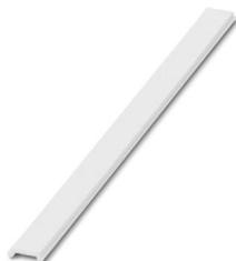
Repérage ZB, plat, Rubans, blanc, vierge, repérable avec : CMS-P1-PLOTTER, PLOTMARK, type de montage: encliquetage dans la rainure de repérage plate, pour bloc de jonction au pas de : 10 mm, surface utile: 5,15 x 10 mm, Nombre d'étiquettes: 10
