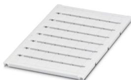
Repères pour blocs de jonction, Planche, blanc, vierge, repérable avec : BLUEMARK ID COLOR, BLUEMARK ID, BLUEMARK CLED, PLOTMARK, CMS-P1-PLOTTER, type de montage: encliquetage dans la rainure de repérage élevée, pour bloc de jonction au pas de : 10,2 mm, surface utile: 9,6 x 10,5 mm, Nombre d'étiquettes: 48
