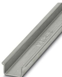
Profilé plein, selon EN 60715, matériau: Acier, galvanisé, traité par passivation couche épaisse, Profil standard 2,3 mm, coloris: argenté
