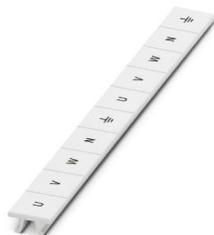
Repères pour blocs de jonction, Rubans, blanc, repéré, repérable avec : CMS-P1-PLOTTER, longitudinal: U, V, W, N, GND, U, V, W, N, GND, type de montage: encliquetage dans la rainure de repérage élevée, pour bloc de jonction au pas de : 10,2 mm, surface utile: 10,15 x 10,5 mm, Nombre d'étiquettes: 10
