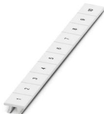
Repérage ZB, Rubans, blanc, repéré, repérable avec : CMS-P1-PLOTTER, impression longitudinale: numérotation continue 1 ... 10, 11 ... 20, etc. jusqu'à 91 ... 100, type de montage: encliquetage dans la rainure de repérage élevée, pour bloc de jonction au pas de : 10,2 mm, surface utile: 10,15 x 10,5 mm, Nombre d'étiquettes: 10
