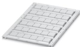
Repères pour blocs de jonction, Planche, blanc, vierge, repérable avec : TOPMARK NEO, LASER TOPMARK, BLUEMARK ID COLOR, BLUEMARK ID, BLUEMARK CLED, THERMOMARK PRIME, THERMOMARK CARD 2.0, THERMOMARK CARD, type de montage: encliquetage dans la rainure de repérage élevée, pour bloc de jonction au pas de : 10,2 mm, surface utile: 8,9 x 9,6 mm, Nombre d'étiquettes: 36
