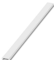
Repérage ZB, plat, à commander : par bandes, blanc, impression selon les indications du client, type de montage: encliquetage dans la rainure de repérage plate, pour bloc de jonction au pas de : 10 mm, surface utile: 5,15 x 10 mm, Nombre d'étiquettes: 10
