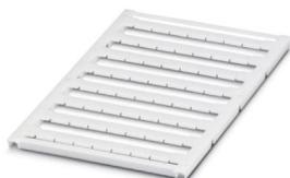
Repères pour blocs de jonction, à commander : sous forme de planche, blanc, impression selon les indications du client, type de montage: encliquetage dans la rainure de repérage plate, pour bloc de jonction au pas de : 8,2 mm, surface utile: 7,6 x 5,1 mm, Nombre d'étiquettes: 56
