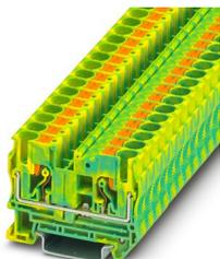
Bloc de jonction pour conducteur de protection, nombre de connexions: 2, nombre de pôles: 1, type de raccordement: Raccordement Push-in, 1er étage, section : 0,5 mm<sup>2</sup> - 10 mm<sup>2</sup>, type de montage: NS 35/7,5, NS 35/15, coloris: vert/jaune
