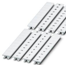
Repères pour blocs de jonction, Rubans, blanc, repéré, repérable avec : CMS-P1-PLOTTER, longitudinal: L1, L2, L3, N, PE, L1, L2, L3, N, PE, type de montage: encliquetage dans la rainure de repérage élevée, pour bloc de jonction au pas de : 8,2 mm, surface utile: 10,5 x 8,15 mm, Nombre d'étiquettes: 10
