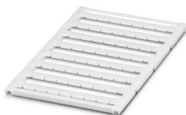
Repères pour blocs de jonction, Plaque, blanc, vierge, repérable avec : BLUEMARK ID COLOR, BLUEMARK ID, BLUEMARK CLED, PLOTMARK, CMS-P1-PLOTTER, type de montage: encliquetage dans la rainure de repérage plate, pour bloc de jonction au pas de : 8,2 mm, surface utile: 7,6 x 5,1 mm, Nombre d'étiquettes: 56
