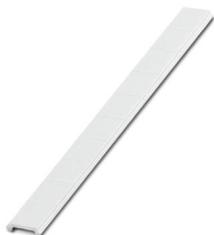
Repérage ZB, plat, à commander : par bandes, blanc, impression selon les indications du client, type de montage: encliquetage dans la rainure de repérage plate, pour bloc de jonction au pas de : 8 mm, surface utile: 5,15 x 8,15 mm, Nombre d'étiquettes: 10
