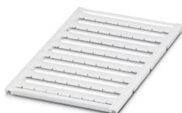
Repères pour blocs de jonction, Planche, blanc, vierge, repérable avec : BLUEMARK ID COLOR, BLUEMARK ID, BLUEMARK CLED, PLOTMARK, CMS-P1-PLOTTER, type de montage: encliquetage dans la rainure de repérage plate, pour bloc de jonction au pas de : 8,2 mm, surface utile: 7,6 x 5,1 mm, Nombre d'étiquettes: 56
