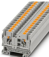
Blocs de jonction simple, tension nominale: 1000 V, intensité nominale: 41 A, type de raccordement: Raccordement Push-in, 1er étage, Section de référence: 6 mm<sup>2</sup>, section : 0,5 mm<sup>2</sup> - 10 mm<sup>2</sup>, type de montage: NS 35/7,5, NS 35/15, coloris: gris
