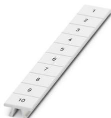
Repérage ZB, Rubans, blanc, repéré, repérable avec : CMS-P1-PLOTTER, impression transversale: numérotation continue 1 ... 10, 11 ... 20, etc. jusqu'à 91 ... 100, type de montage: encliquetage dans la rainure de repérage élevée, pour bloc de jonction au pas de : 8,2 mm, surface utile: 10,5 x 8,15 mm, Nombre d'étiquettes: 10
