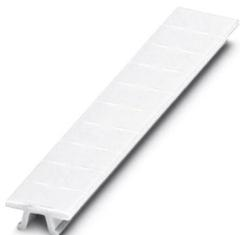
Repérage ZB, à commander : par bandes, blanc, impression selon les indications du client, type de montage: encliquetage dans la rainure de repérage élevée, pour bloc de jonction au pas de : 6,2 mm, surface utile: 6,15 x 10,5 mm, Nombre d'étiquettes: 10
