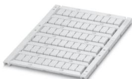
Repères pour blocs de jonction, Planche, blanc, vierge, repérable avec : TOPMARK NEO, LASER TOPMARK, BLUEMARK ID COLOR, BLUEMARK ID, BLUEMARK CLED, THERMOMARK PRIME, THERMOMARK CARD 2.0, THERMOMARK CARD, type de montage: encliquetage dans la rainure de repérage élevée, pour bloc de jonction au pas de : 6,2 mm, surface utile: 5,6 x 10,5 mm, Nombre d'étiquettes: 60
