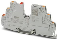
Disjoncteur d'appareil électronique monocanal, avec limitation de courant active pour la protection de quatre consommateurs à 24 V DC en cas de surcharge et de court-circuit. Répartition facile du potentiel avec les composants du système de blocs de jonction CLIPLINE complete. Avec dispositif de verrouillage électronique des intensités nominales réglées. Pour une installation sur des rails DIN.
