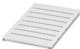
Repères pour blocs de jonction, Planche, blanc, vierge, repérable avec : BLUEMARK ID COLOR, BLUEMARK ID, BLUEMARK CLED, PLOTMARK, CMS-P1-PLOTTER, type de montage: encliquetage dans la rainure de repérage élevée, pour bloc de jonction au pas de : 6,2 mm, surface utile: 5,6 x 10,5 mm, Nombre d'étiquettes: 80
