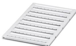
Repères pour blocs de jonction, Planche, blanc, vierge, repérable avec : BLUEMARK ID COLOR, BLUEMARK ID, BLUEMARK CLED, PLOTMARK, CMS-P1-PLOTTER, type de montage: encliquetage dans la rainure de repérage plate, pour bloc de jonction au pas de : 6,2 mm, surface utile: 5,6 x 5,1 mm, Nombre d'étiquettes: 80
