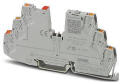
Fusible électronique monocanal pour protéger les récepteurs de 24 V. Répartition facile du potentiel, avec les blocs de jonction du système CLIPLINE complete. Avec sortie d'état, entrée de remise à zéro et mécanisme de verrouillage électronique. Pour l'installation sur des rails DIN.
