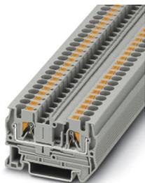
Blocs de jonction simple, tension nominale: 800 V, intensité nominale: 32 A, type de raccordement: Raccordement Push-in, 1er étage, Section de référence: 4 mm<sup>2</sup>, section : 0,2 mm<sup>2</sup> - 6 mm<sup>2</sup>, type de montage: NS 35/7,5, NS 35/15, coloris: gris
