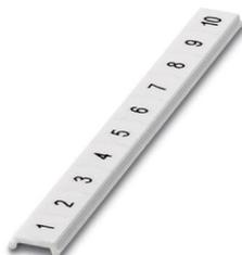
Repérage ZB, plat, Rubans, blanc, repéré, impression longitudinale: numérotation continue 1 ... 10, 11 ... 20, etc. jusqu'à 91 ... 100, type de montage: encliquetage dans la rainure de repérage plate, pour bloc de jonction au pas de : 6,2 mm, surface utile: 5,15 x 6,15 mm, Nombre d'étiquettes: 10
