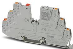
Fusible électronique monocanal pour protéger les récepteurs de 24 V. Répartition facile du potentiel, avec les blocs de jonction du système CLIPLINE complete. Avec sortie d'état, entrée de remise à zéro et mécanisme de verrouillage électronique. Pour l'installation sur des rails DIN.
