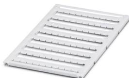
Repères pour blocs de jonction, à commander : sous forme de planche, blanc, impression selon les indications du client, type de montage: encliquetage dans la rainure de repérage plate, pour bloc de jonction au pas de : 6,2 mm, surface utile: 5,6 x 5,1 mm, Nombre d'étiquettes: 80
