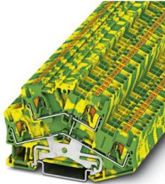
Bloc de jonction à 2 niveaux pour conducteur protection, nombre de connexions: 4, type de raccordement: Raccordement Push-in, 1er étage, section : 0,14 mm<sup>2</sup> - 4 mm<sup>2</sup>, type de montage: NS 35/7,5, NS 35/15, coloris: vert/jaune
