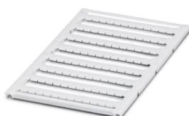
Repères pour blocs de jonction, Planche, blanc, vierge, repérable avec : BLUEMARK ID COLOR, BLUEMARK ID, BLUEMARK CLED, PLOTMARK, CMS-P1-PLOTTER, type de montage: encliquetage dans la rainure de repérage plate, pour bloc de jonction au pas de : 5,2 mm, surface utile: 4,6 x 5,1 mm, Nombre d'étiquettes: 96
