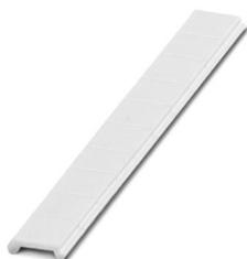
Repérage ZB, plat, Rubans, blanc, vierge, repérable avec : PLOTMARK, CMS-P1-PLOTTER, type de montage: encliquetage dans la rainure de repérage plate, pour bloc de jonction au pas de : 5 mm, surface utile: 5,1 x 5,2 mm, Nombre d'étiquettes: 10
