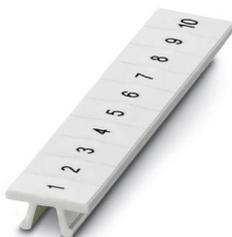
Repérage ZB, Rubans, blanc, repéré, impression longitudinale: numérotation continue 1 ... 10, 11 ... 20, etc. jusqu'à 491 ... 500, type de montage: encliquetage dans la rainure de repérage élevée, pour bloc de jonction au pas de : 5,2 mm, surface utile: 5,15 x 10,5 mm, Nombre d'étiquettes: 10
