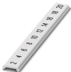
Repérage ZB, plat, Rubans, blanc, repéré, impression longitudinale, type de montage: encliquetage dans la rainure de repérage plate, pour bloc de jonction au pas de : 5 mm, surface utile: 5,15 x 5,15 mm, Nombre d'étiquettes: 10
