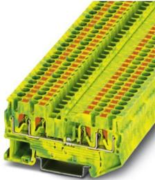
Bloc de jonction pour conducteur de protection, nombre de connexions: 4, type de raccordement: Raccordement Push-in, 1er étage, Section de référence: 2,5 mm<sup>2</sup>, section : 0,14 mm<sup>2</sup> - 4 mm<sup>2</sup>, type de montage: NS 35/7,5, NS 35/15, coloris: vert/jaune
