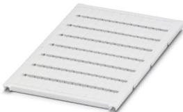
Repères pour blocs de jonction, Plaque, blanc, vierge, repérable avec : BLUEMARK ID COLOR, BLUEMARK ID, BLUEMARK CLED, PLOTMARK, CMS-P1-PLOTTER, type de montage: encliquetage dans la rainure de repérage élevée, pour bloc de jonction au pas de : 5,2 mm, surface utile: 10,5 x 4,6 mm, Nombre d'étiquettes: 96
