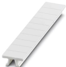
Repérage ZB, Rubans, blanc, vierge, repérable avec : PLOTMARK, CMS-P1-PLOTTER, type de montage: encliquetage dans la rainure de repérage élevée, pour bloc de jonction au pas de : 5,2 mm, surface utile: 5,1 x 10,5 mm, Nombre d'étiquettes: 10
