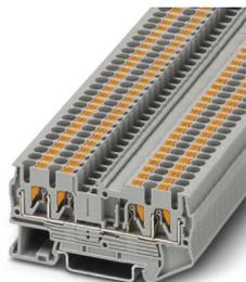
Blocs de jonction simple, tension nominale: 800 V, intensité nominale: 24 A, type de raccordement: Raccordement Push-in, Section de référence: 2,5 mm<sup>2</sup>, section : 0,14 mm<sup>2</sup> - 4 mm<sup>2</sup>, type de montage: NS 35/7,5, NS 35/15, coloris: gris
