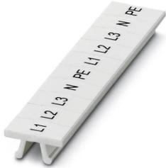
Repérage ZB, Rubans, blanc, repéré, longitudinal: L1, L2, L3, N, PE, L1, L2, L3, N, PE, type de montage: encliquetage dans la rainure de repérage élevée, pour bloc de jonction au pas de : 5,2 mm, surface utile: 5,15 x 10,5 mm, Nombre d'étiquettes: 10
