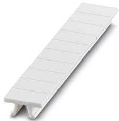
Repérage ZB, à commander : par bandes, blanc, impression selon les indications du client, type de montage: encliquetage dans la rainure de repérage élevée, pour bloc de jonction au pas de : 5,2 mm, surface utile: 5,15 x 10,5 mm, Nombre d'étiquettes: 10
