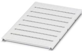
Repères pour blocs de jonction, à commander : sous forme de planche, blanc, impression selon les indications du client, type de montage: encliquetage dans la rainure de repérage élevée, pour bloc de jonction au pas de : 5,2 mm, surface utile: 10,5 x 4,6 mm, Nombre d'étiquettes: 96
