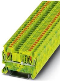
Bloc de jonction pour conducteur de protection, nombre de connexions: 2, type de raccordement: Raccordement Push-in, 1er étage, section : 0,14 mm<sup>2</sup> - 4 mm<sup>2</sup>, type de montage: NS 35/7,5, NS 35/15, coloris: vert/jaune
