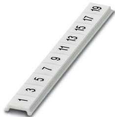
Repérage ZB, plat, Rubans, blanc, repéré, impression longitudinale: numérotation impaire 1-19, 21-39, etc. jusqu'à 81-99, type de montage: encliquetage dans la rainure de repérage plate, pour bloc de jonction au pas de : 5 mm, surface utile: 5,15 x 5,15 mm, Nombre d'étiquettes: 10
