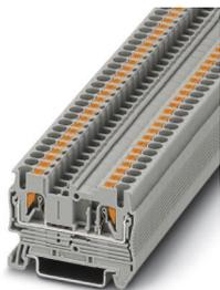
Blocs de jonction simple, tension nominale: 800 V, intensité nominale: 24 A, type de raccordement: Raccordement Push-in, 1er étage, Section de référence: 2,5 mm<sup>2</sup>, section : 0,14 mm<sup>2</sup> - 4 mm<sup>2</sup>, section : 0,14 mm<sup>2</sup> - 4 mm<sup>2</sup>, type de montage: NS 35/7,5, NS 35/15, coloris: gris
