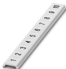
Repérage ZB, plat, Rubans, blanc, repéré, impression longitudinale: numérotation continue 1 ... 10, 11 ... 20, etc. jusqu'à 491 ... 500, type de montage: encliquetage dans la rainure de repérage plate, pour bloc de jonction au pas de : 5 mm, surface utile: 5,15 x 5,15 mm, Nombre d'étiquettes: 10
