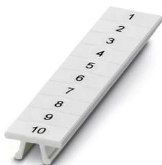
Repérage ZB, blanc, impression transversale: numérotation continue 1 ... 10, 11 ... 20, etc. jusqu'à 491 ... 500, type de montage: encliquetage dans la rainure de repérage élevée, pour bloc de jonction au pas de : 5,2 mm, surface utile: 5,15 x 10,5 mm
