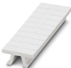
Repérage ZB, Rubans, blanc, vierge, repérable avec : PLOTMARK, CMS-P1-PLOTTER, type de montage: encliquetage dans la rainure de repérage élevée, pour bloc de jonction au pas de : 3,5 mm, surface utile: 3,5 x 10,5 mm, Nombre d'étiquettes: 10
