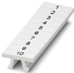
Repérage ZB, Rubans, blanc, repéré, impression transversale: numérotation continue 1 ... 10, 11 ... 20, etc. jusqu'à 91 ... 100, type de montage: encliquetage dans la rainure de repérage élevée, pour bloc de jonction au pas de : 3,5 mm, surface utile: 3,5 x 10,5 mm, Nombre d'étiquettes: 10
