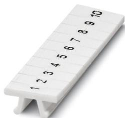
Repérage ZB, Rubans, blanc, repéré, impression longitudinale: numérotation continue 1 ... 10, 11 ... 20, etc. jusqu'à 91 ... 100, type de montage: encliquetage dans la rainure de repérage élevée, pour bloc de jonction au pas de : 3,5 mm, surface utile: 3,5 x 10,5 mm, Nombre d'étiquettes: 10
