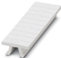
Repérage ZB, à commander : par bandes, blanc, impression selon les indications du client, type de montage: encliquetage dans la rainure de repérage élevée, pour bloc de jonction au pas de : 3,5 mm, surface utile: 3,5 x 10,5 mm, Nombre d'étiquettes: 10
