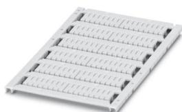
Repères pour blocs de jonction, Planche, blanc, vierge, repérable avec : TOPMARK NEO, LASER TOPMARK, BLUEMARK ID COLOR, BLUEMARK ID, BLUEMARK CLED, THERMOMARK PRIME, THERMOMARK CARD 2.0, THERMOMARK CARD, type de montage: encliquetage dans la rainure de repérage élevée, pour bloc de jonction au pas de : 3,5 mm, surface utile: 2,95 x 10,5 mm, Nombre d'étiquettes: 102
