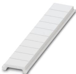
Repérage ZB, plat, à commander : par bandes, blanc, impression selon les indications du client, type de montage: encliquetage dans la rainure de repérage plate, pour bloc de jonction au pas de : 3,5 mm, surface utile: 3,5 x 5,2 mm, Nombre d'étiquettes: 10
