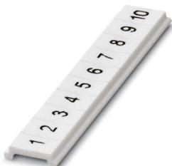
Repérage ZB, plat, Rubans, blanc, repéré, impression longitudinale: numérotation continue 1 ... 10, 11 ... 20, etc. jusqu'à 91 ... 100, type de montage: encliquetage dans la rainure de repérage plate, pour bloc de jonction au pas de : 3,5 mm, surface utile: 5,15 x 3,5 mm, Nombre d'étiquettes: 10
