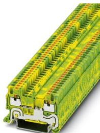
Bloc de jonction pour conducteur de protection, nombre de connexions: 2, type de raccordement: Raccordement Push-in, 1er étage, section : 0,14 mm<sup>2</sup> - 1,5 mm<sup>2</sup>, type de montage: NS 35/7,5, NS 35/15, coloris: vert/jaune
