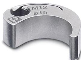
Embout enfichable pour le montage de câbles de capteurs/actionneurs munis de connecteurs M12 et de connecteurs M12 à équiper avec diamètre d'écrou moleté de 15 mm, pour emmanchement à six pans de 4 mm
