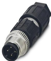
Connecteur, Universel, 4-pôles, connecteur mâle droit M12, Détrompage: A, Raccordement autodénudant, matériau de la molette: Zinc moulé sous pression, nickelé, diamètre extérieur du câble 3,5 mm ... 6 mm
