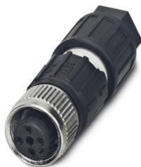
Connecteur, Universel, 4-pôles, connecteur femelle droit M12, Détrompage: A, Raccordement autodénudant, matériau de la molette: Zinc moulé sous pression, nickelé, diamètre extérieur du câble 3,5 mm ... 6 mm
