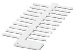
Etiquette, Rubans, blanc, vierge, repérable avec : CMS-P1-PLOTTER, type de montage: enfilage, plage de diamètre de câble: 1,5 ... 35 mm, surface utile: 23 x 4 mm, Nombre d'étiquettes: 20
