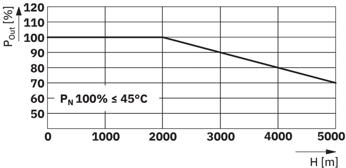
Puissance de sortie, altitude d'installation
