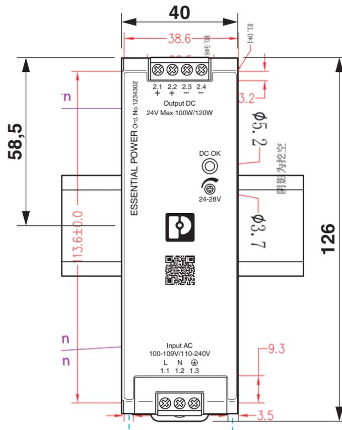
Encombrement de l'appareil (cotes en mm)
