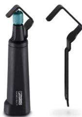
**Outil à dénuder**, pour le dénudage de câbles de Ø 4,5 mm à 40 mm, épaisseur d'élément de contact jusqu'à 4,5 mm, couteau pivotant pour coupes rondes, longues et en spirale
